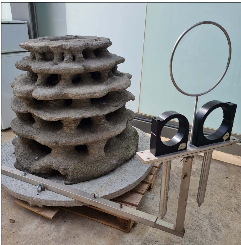
Figura 16: foto del brazo de soporte de la cámara submarina. La cámara y el pack batería (módulos circulares) se instalarán en las dos anillas de color negro. El sistema de cámara + baterías es fácilmente removible del resto del brazo, y re-instalable en el mismo. La anilla metálica sirve de mango para la manipulación del sistema por parte del ROV.
