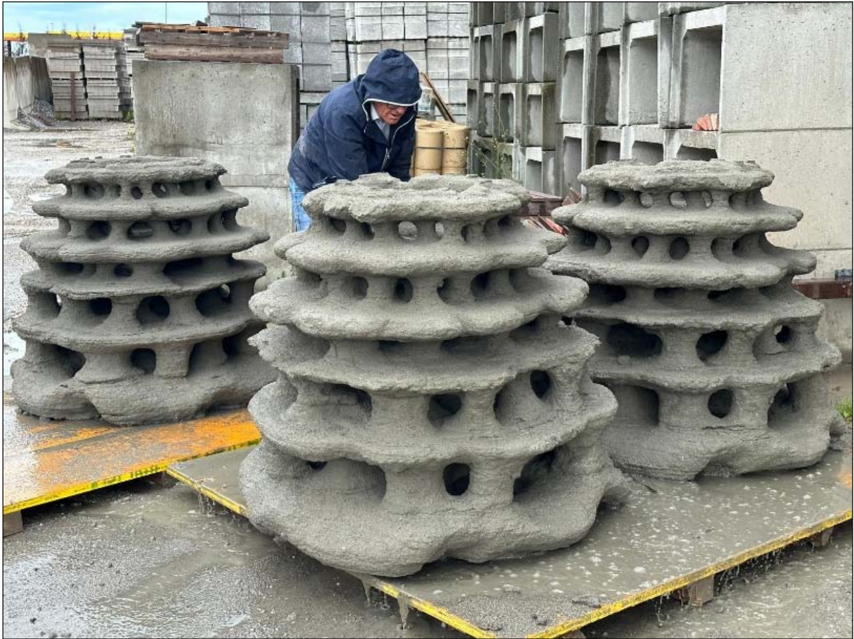
Figura 13: fotografía de los módulos arrecifales que se instalarán en el Seco de los Olivos, en el marco del proyecto DREAM
